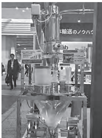
写真-2 バキュームコンベア
