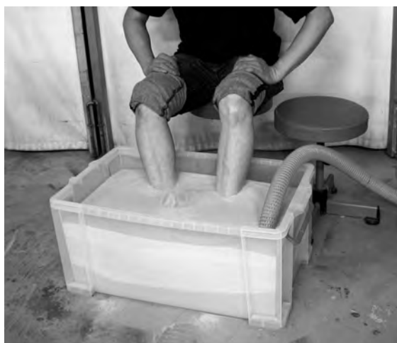
写真-15 流動床を用いた足湯
