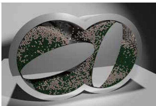
粉体シミュレーション（混合機の粒子挙動アニメーション）
