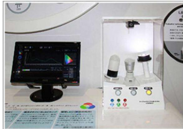
産総研が日亜化学工業(株)と共同開発した「標準 LED」と、市販の LED 電球、3 原色 (R/G/B) LED、それぞれのスペクトルをディスプレイで確認しながら比べることができます。3 原色 LED では、RGB の 3 つのボリュームを調整して、光色の調合体験もできます。もちろんそのときのスペクトルもリアルタイムでディスプレイに表示します。「標準 LED」は、LED 照明の明るさの基準として、メーカーで使用してもらうために開発されたものです。何種類もの色合いの違う LED 素子と何種類もの蛍光体 (青色の光を吸収して、赤・黄・緑などの光を出す) を組み合わせることで、可視光全域をカバーするスペクトルを実現しました。この標準 LED は、すでに日亜化学工業(株)より販売されています。
